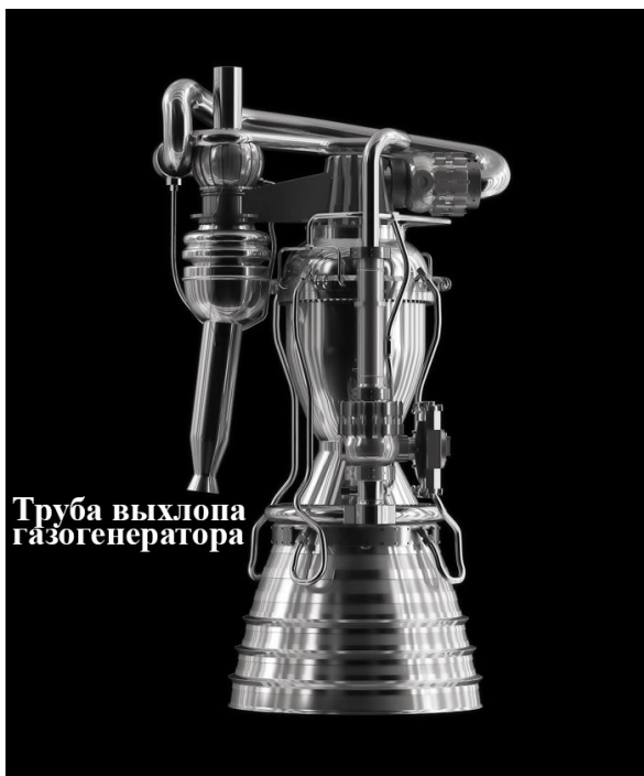
Рисунок 1 - Двигатель открытого цикла Merlin 1D
